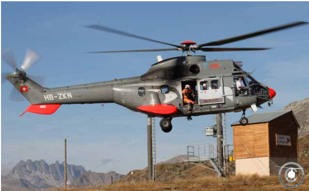
Le SUPER PUMA en action: le helper assujéti à la machine en liaison avec le pilote surveille d'éventuels obstacles au niveau du rotor de queue.
